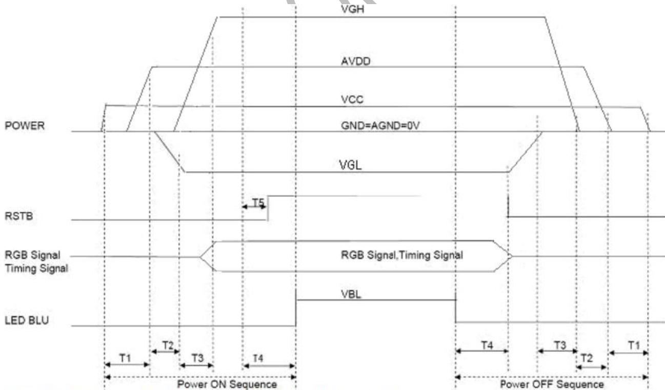
Note 1:  $T1 \geq 20ms$ ,  $T2 \geq 20ms$ ,  $T3 \geq 5ms$ ,  $T4 \geq 100ms$ ,  $T5 \geq 5ms$ .
