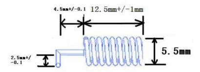
弹簧线径: 0.8mm, 圈数: 9圈
