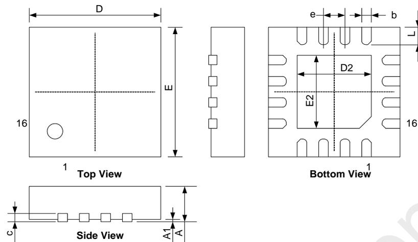
Figure 2. 16-Pin QFN 3x3 Package
