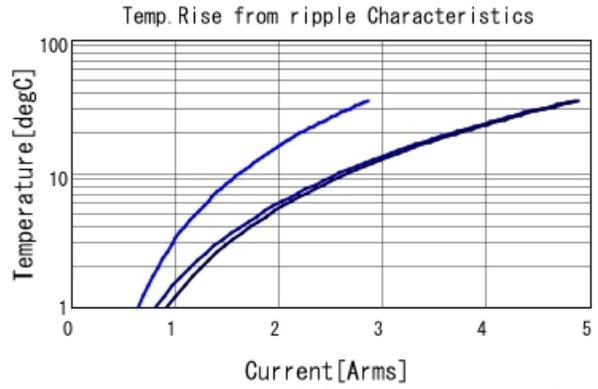
GRM31MR71C225KA35 Temp. rise ■ 100kHz ■ 500kHz ■ 1MHz
