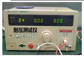
在气泵引线与外壳之间施加 2.5KV50HZ 的电压,实验时间为 4 秒,漏电流限制设置为 0.2mA,不应发生击穿和报警;
