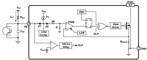
**Figure 21. OLP Circuit**
