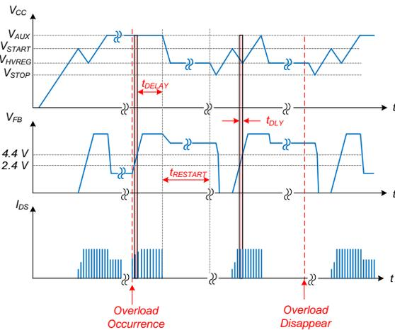
**Figure 20. OLP Waveforms**
