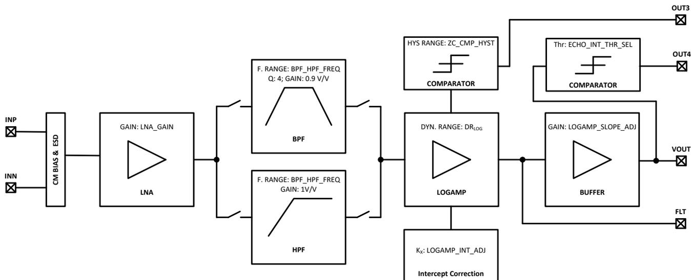
Figure 21. TUSS4470 Analog Front-End Block Diagram
